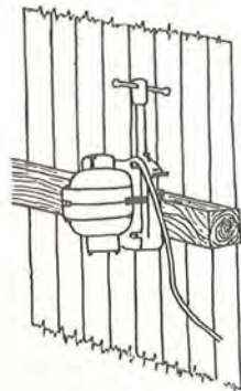
Fig. 213. Formvibrator. Maskinstampning anvendes ofte til Komprimering af Vejbaner o.l.
